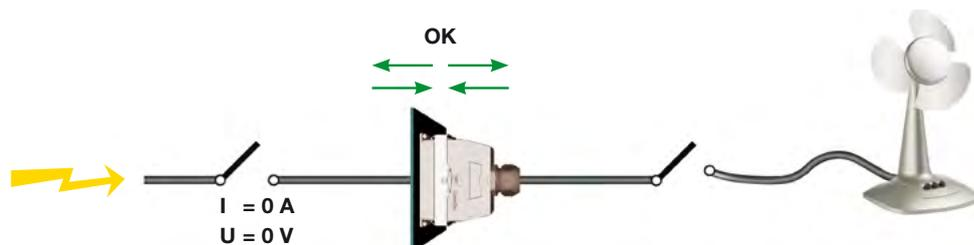
Embrochage et débrochage lorsque le connecteur est branché sur le réseau électrique et n'est pas sous charge
