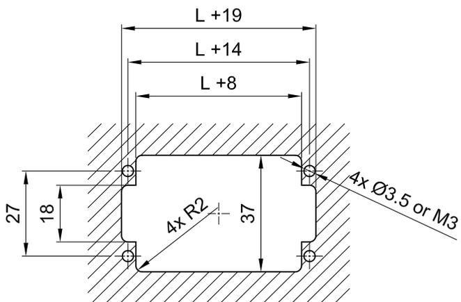
Montage du boîtier léger pour CombiTac avec terminaisons pour boîtier
