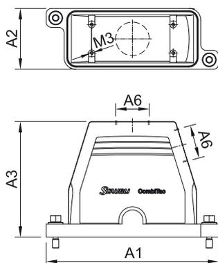
Le contact complet entre les deux moitiés formant les boîtiers IP68/69K fournit une protection à 360° contre les ondes électromagnétiques conformément à VG 95373-41.
