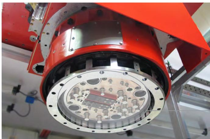
Système de connexion avec CombiTac pour établir une liaison entre les différentes têtes de fraisage et l'entraînement.
