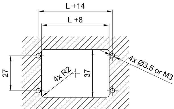
Montage sur panneaux côté douilles pour CombiTac avec terminaisons pour boîtier
