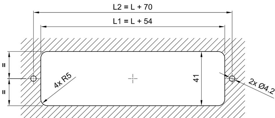
Montage sur panneaux côté broches pour CombiTac avec terminaisons pour boîtier
