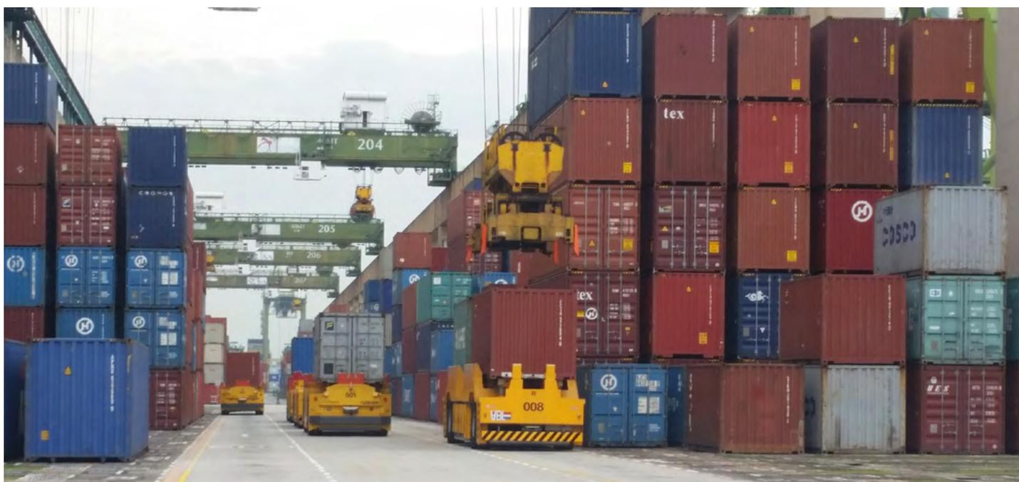
到 2040 年,当 PSA Singapore 大士港全面投入运营时,其将成为全球最大的全自动集装箱码头。在这个新的大型港口的准备建设过程中,对电池供电的AGV车队的自动充电系统进行了测试和评估,这些 AGV 的载重量为 65 吨,巡航速度为 25 km/h。
