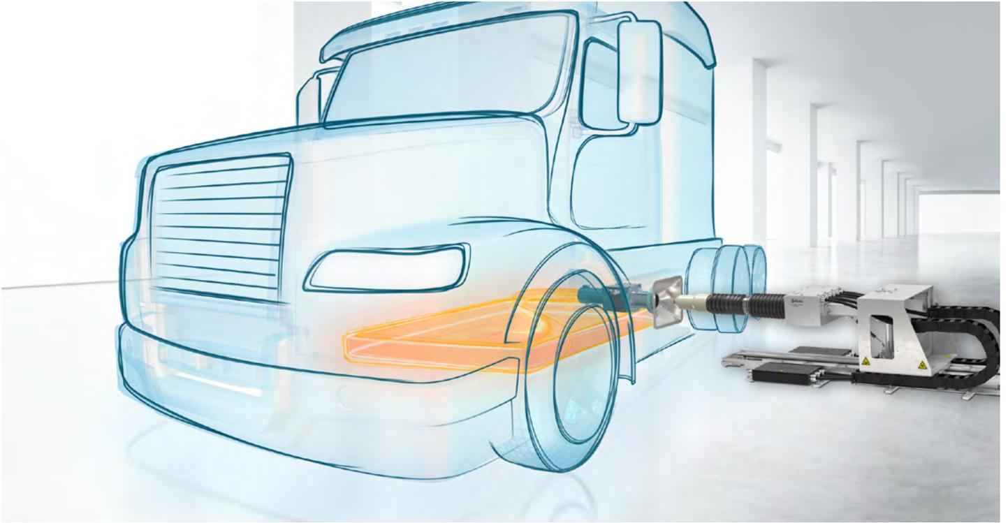
Mit dem innovativen QCC für Hochleistungs-Ladesysteme bietet Stäubli eine universelle Lösung für das automatisierte Laden von verschiedenen Arten von Elektrofahrzeugen, wie z.B. FTS, Busse, LKW, mobile Maschinen und Schiffe.
