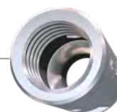
Raccord AxiClamp avec bague tournante, évite la rotation du câble pendant le serrage.
