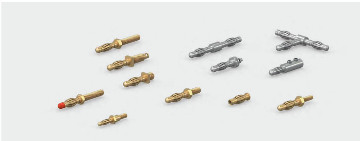
Les fiches à lamelles de Stäubli sont fabriquées en laiton doré ou nickelé. Un contact à lamelles est monté flottant dans une gorge. L'action exercée par les lamelles garantit une pression de contact constante à l'état connecté. Nos fiches à lamelles présentent des propriétés électriques exceptionnelles sont équipées de deux types de lamelles, «twisted» ou droites.
