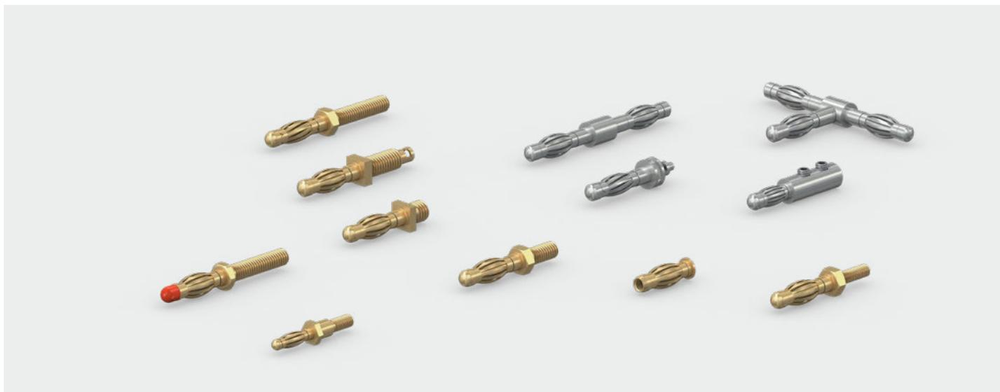
ストープリMULTILAMプラグは、金メッキまたはニッケルメッキを施した真鍮製です。くぼみ部分は、自由に移動可能なMULTILAMコンタクトケージのためのシートとして機能します。ルーバーのバネ作用は、優れた電気特性を保証しながら、嵌合状態で一定の圧力がかかります。当社のMULTILAMプラグには、ツイストとストレートの2種類のMULTILAMがございます。
