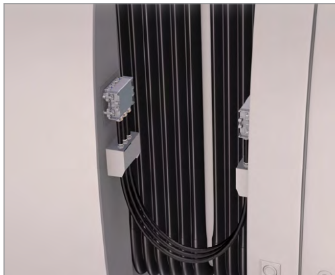
Beispiele für Wagenübergänge mit geradem und gewinkelten EvoTrak MPC-Steckkombinationen. Sogar 3-stöckige Lösungen sind möglich.
