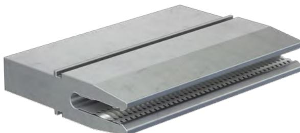
Les fourches de contact sont réalisées à partir d'un profilé, coupé à longueur, argenté, avant d'être équipé d'un contact à lamelles Stäubli. Cette technique de fabrication permet de réaliser des fourches de largeur variable.
