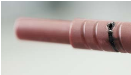
Durchschlag bei nicht normkonformem Steckverbinder
