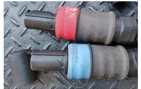
Tag vollelektrisch bis zu 100 km zurücklegen können. Die Batterien haben eine Kapazität von 1240 Ah und befinden sich im unteren Schiffsdeck, die Ladestation befindet sich an Land und ist mit einpoligen Anschlüssen ausgestattet. Im Zuge der Modernisierung der Infrastruktur und der Erhöhung der Sicherheit der Ladeanschlüsse wurden die früheren Stäubli-Steckverbinder durch Stäublis Folgeprodukt ersetzt: dem einpoligen Steckverbinder 16BL.
