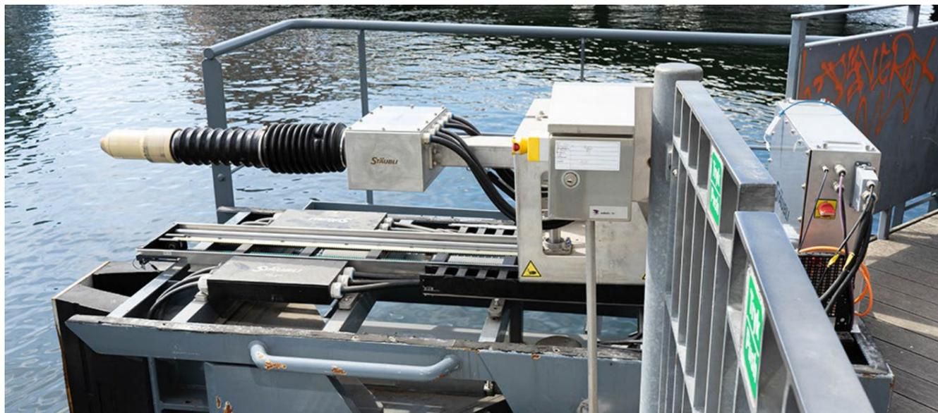
Die Ladelösung QCC ermöglicht es, die batteriebetriebenen Schiffe in nur sechs Minuten aufzuladen, ohne dass der Fahrplan beeinträchtigt wird.
