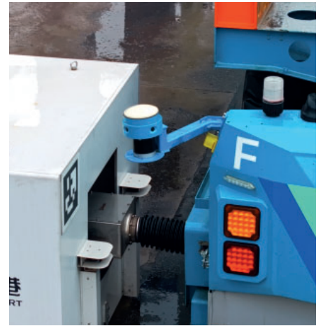
QCC 充电连接器和 ART 处于连接充电状态。
