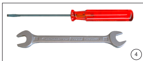
(图4) 螺丝刀尺寸 0 开口扳手压接: 9 mm, 10 mm 开口扳手 SMA: 8 mm, 11 mm
