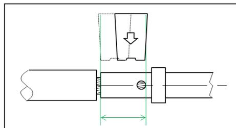
L'indent doit être placé entre le bord du fût de sertissage et l'extrémité du regard. Le positionnement optimal consiste à installer l'indent entre le bord du fût de sertissage et l'ouverture du regard.
