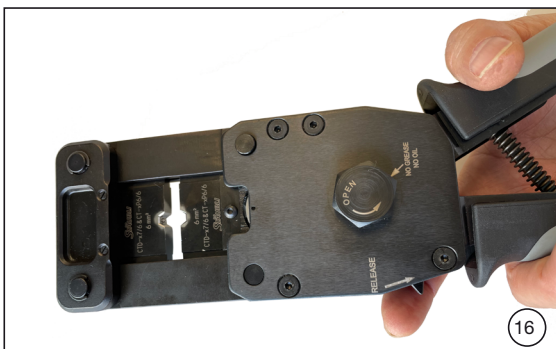
(ill. 16) Handgriffe leicht schließen bis sich der Entlastungshebel nach unten aus der Zahnstruktur drücken lässt.
