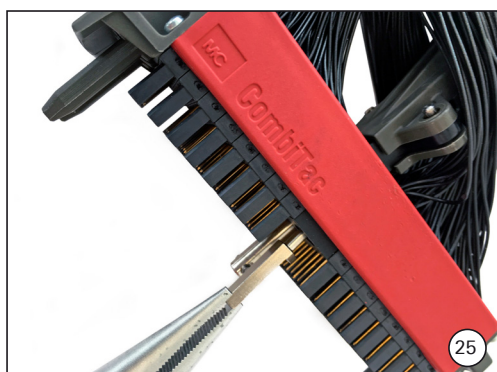
(ill. 25) 更改编码位置, 将编码销重新装回插槽。
