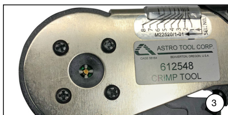
(图 3) 将压接套插入压接钳。合拢压接钳直至将压接套固定好。
