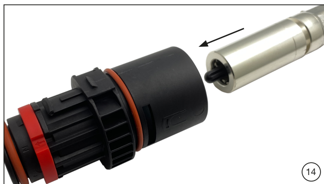
(图14 - 15) 将压接好金属触子完全插入前端连接器绝缘外壳内。将固定夹插入连接器顶部的狭缝中，将触子固定到位。必须完全插入，并与绝缘体表面齐平。
