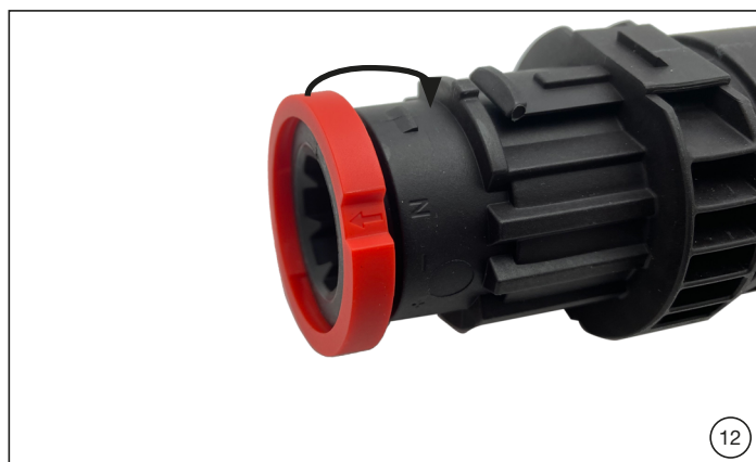
(图12 - 13) 将彩色编码环上的箭头与所需的编码位置对齐。将编码环滑动至连接器绝缘层前部。正确安装后，箭头将指向所需的编码标记。可用的机械编码位置有 PE、+、-、N、L1、L2 和 L3。有关编码环的更多信息和颜色选项，请参见第 10 页。 仅适用于套筒：然后将密封环滑入到位。
