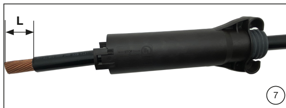
(图7) 将外壳滑动，串至电缆上，预留的可滑动距离应足够大，以便有足够的空间剥线和压接电缆。然后将电缆绝缘层剥离至长度 L (请参见第 7 页的表 2 或表 3)。
