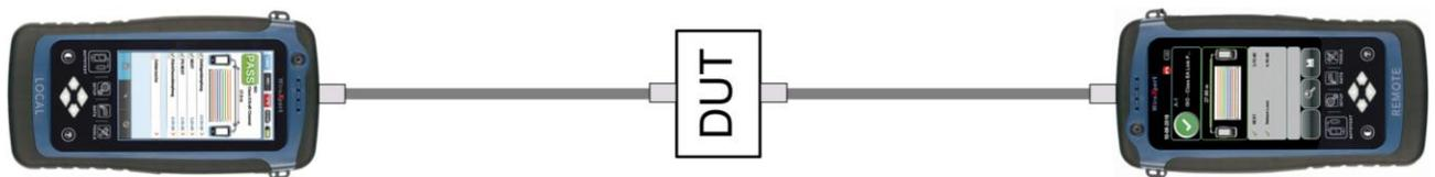
Illustration 1: Structure de mesure pour l'objet testé (device under test : DUT) dans ce cas le CT-NET/CTD-NET
