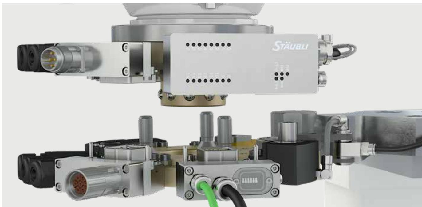
**制御、監視、報告:** 新たに開発された IDA 内臓バスモジュールは、ツール内にある個別のセンサーとアクチュエーターを使ってそれぞれのツール交換プロセスと通信することができます。装置は、標準ProfiNet、イーサネットIP、Modbusプロトコルで高いレベルの制御ユニットと通信します。
