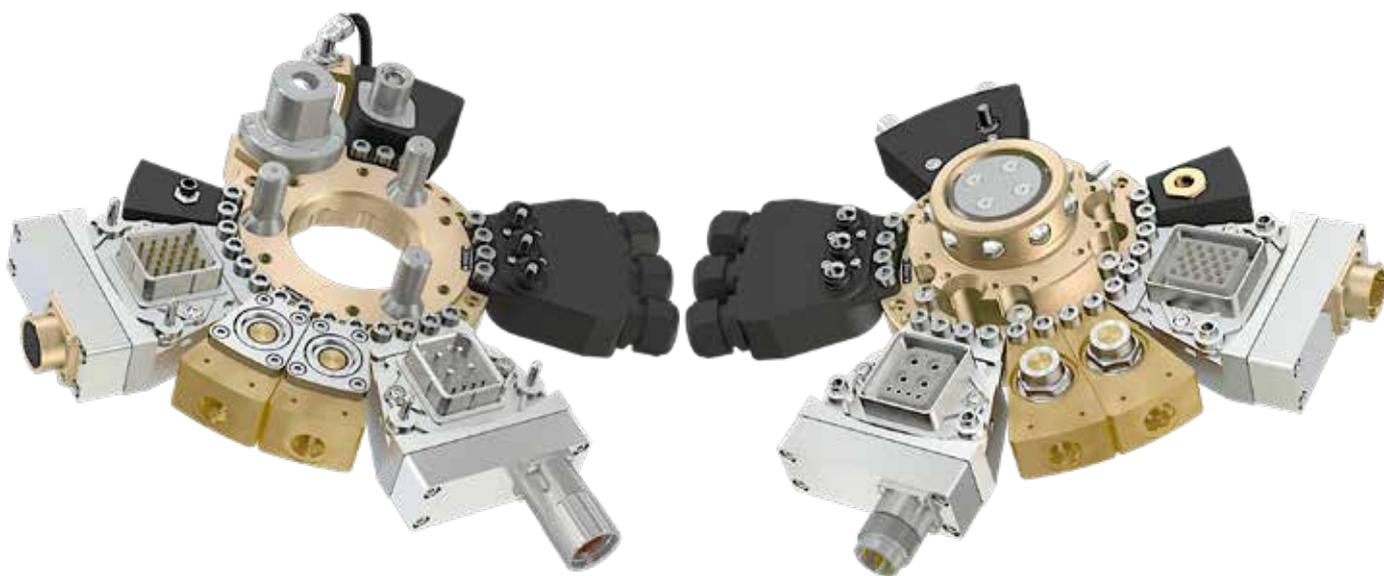
すべてのメディアカップリングと電気モジュールに統合されたコネクタはフローティングコンタクトテクノロジーを採用。それにより、精度が高まり数百万回のドッキングサイクル後も精度の高い接続ができるため、摩耗を最小限に抑えます。メンテナンスの際、ロボットワークフローに対して最小限の中断が生じるため部品を迅速に交換することが可能です。
