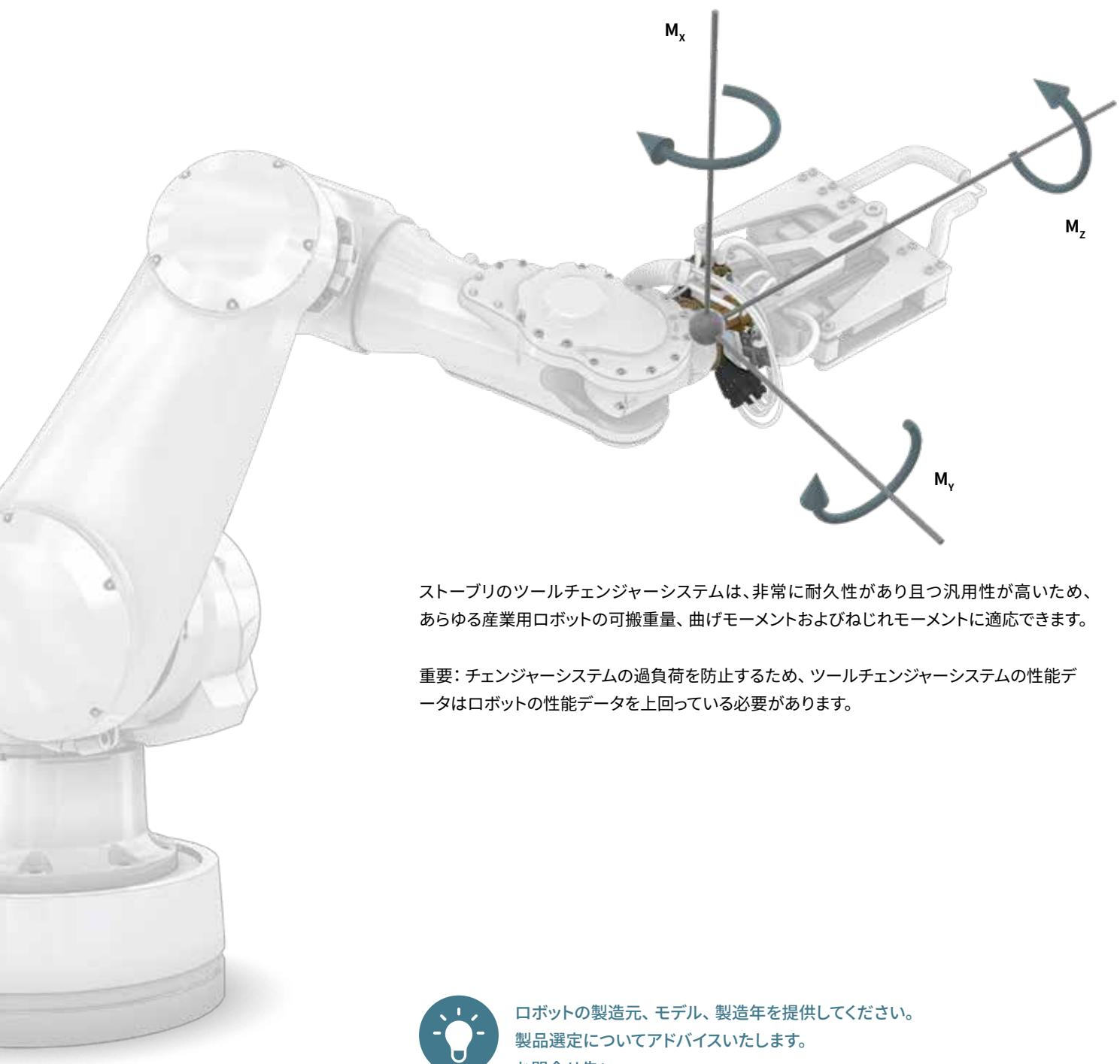
ストーブリのツールチェンジャーシステムは、非常に耐久性があり且つ汎用性が高いため、あらゆる産業用ロボットの可搬重量、曲げモーメントおよびねじれモーメントに適応できます。
