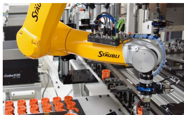
Die Montage von fünf Millionen Hochvolt-Steckern jährlich für Elektro- und Hybridfahrzeuge stellt hohe Ansprüche an die Automation. Bei der Eberhard AG übernimmt einer der insgesamt sechs verbauten TX2-60L von Stäubli das Einlegen eines Steckergehäuses in den Werkstückträger.
