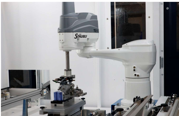
Voltjet Montageanlage, Nordfels, Österreich: Ein SCARA TS2-60 in ESD-Ausführung nimmt die Rundzellen in Empfang und setzt sie in stehender Position in einen kundenspezifischen Battery Pack ein.
