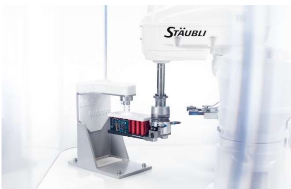
Die SCARA Roboter von Stäubli in ESD-Ausführung (ESD = Electrostatic Discharge) sind perfekt geeignet für die präzise Montage von Battery Packs.
