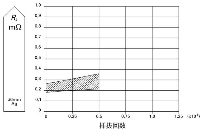
接触抵抗 $R_k$ は、ILL.1が示す試験方および、方程式に従った計算により決定します。
