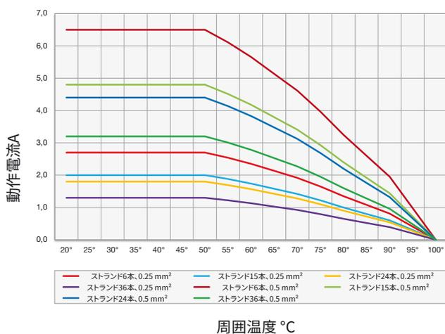
NBR/CR: ケーブル0.75 mm<sup>2</sup> & 1 mm<sup>2</sup>
