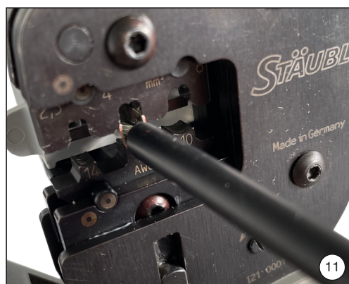
(图 11) • 插入剥皮后的电缆末端, 使电缆铜丝与定位块充分接触。 • 再压紧压接钳。 • 打开嵌块 • 取出压接好的金属针。
